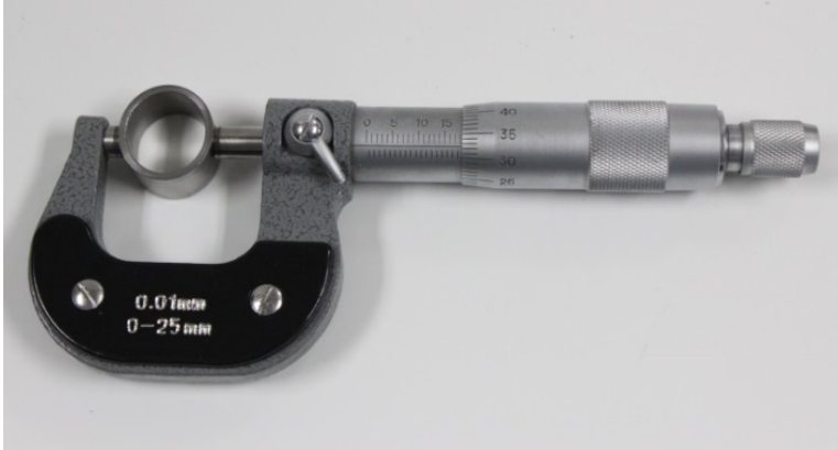
Figure 9 : Mesure de la déformation de l'anneau dynamométrique.
