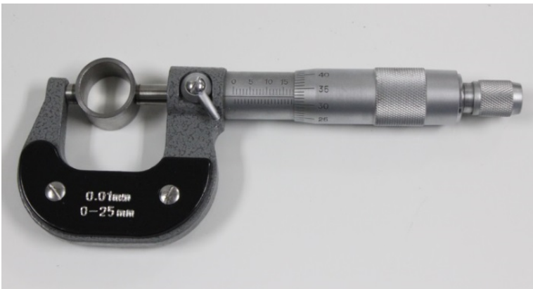
Figura 9: Misurazione della deformazione dell'anello di prova.
