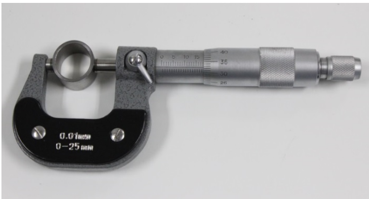
Obr. 9 Meranie deformácie silomerného kruhu
