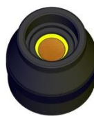
Vzorek zadržovací kruh vložený v příslušenství spolu se vzorkem písku a rozpěra
