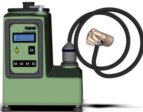
Obr. 5.5.1 Utěsnění příslušenství na měření prodyšnosti formy rukou
