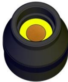
Spécimen bague de retenue avec l'échantillon de sable inséré dans
