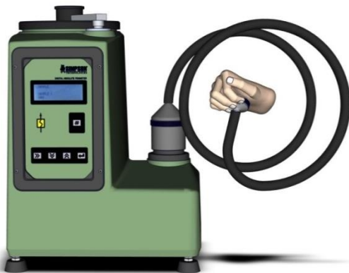
Figure 5.5.1 - Boucher à la main la tête de mesure de l'accessoire
