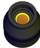
Spécimen bague de retenue avec l'échantillon de sable et l'entretoise insérés dans l'accessoire
