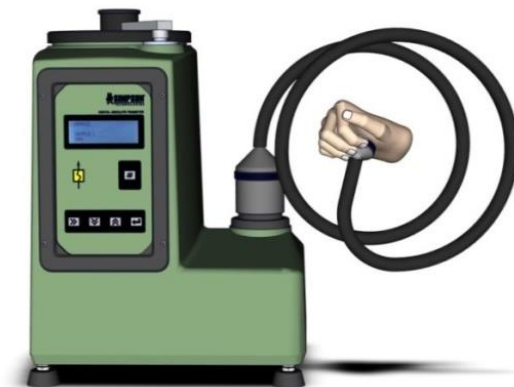
Obr. 5.5.1 Utesnenie príslušenstva na meranie priepustnosti formy rukou
