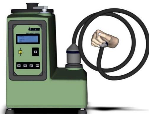
**Abb. 5.5.1 - Abdichten mittels Hand des Zubehörs für Gasdurchlässigkeit an der Form**
