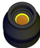
**Probenhaltering mit Prüfkörper
