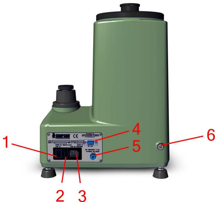
Figura 1: Vista posterior del permeámetro mostrando las conexiones neumáticas, eléctricas y conexión a PC
