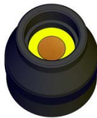
Anillo de retención del espécimen con la muestra insertada en espaciador insertado
