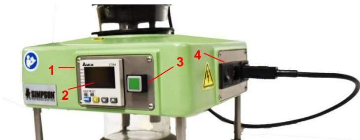
Figura 3: Pannelli di Potere e di Controllos
