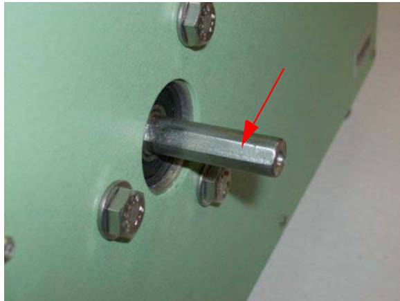
Abbildung 1: Flacher Teil auf der Welle
