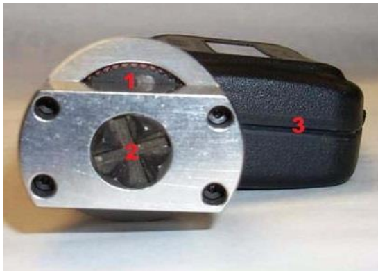
Abb. 6: Halterung (1), Ritzwerkzeug (2) und Probe (3)
