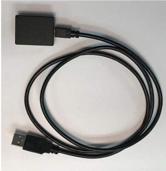
Figur 3: USB-kabel og infrarød IR-modtager
