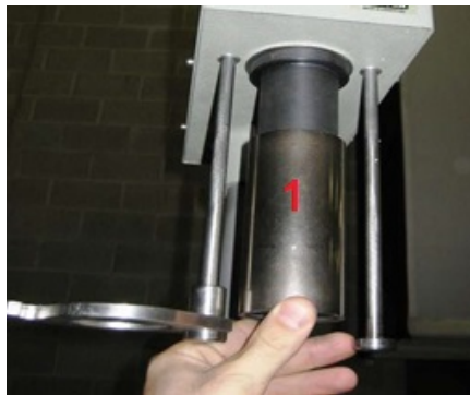
Figura 10: 2 "x 2" (50 mm x 50 mm) tubo de muestra (1) situado en el poste del Probador de índice de rotura
