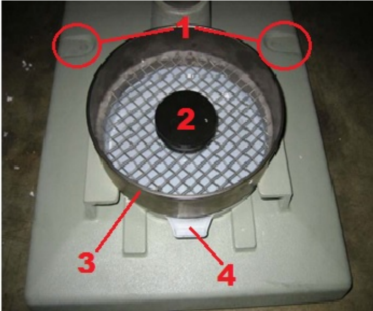
Figure 3: Base del Probador de índice de rotura con el tamiz de malla 1/2" (3), bandeja (4) y objetivo (2).
