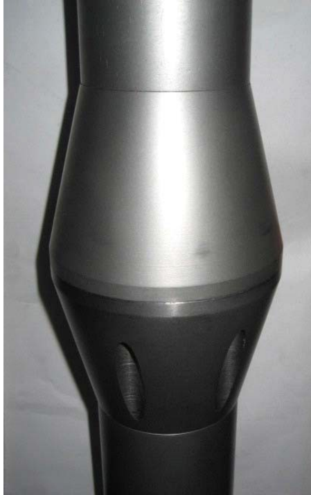
Figura 2: Acoplamiento de las dos secciones del Probador de índice de rotura.
