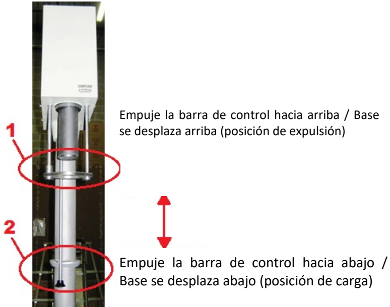
Figura 8: Poste de Probador de índice de rotura en la posición inferior cerrada
