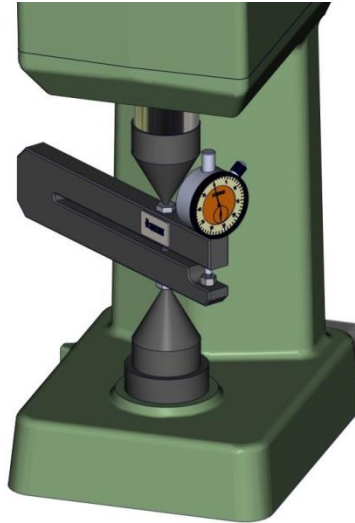
Abbildung 9: Mechanische Druckgabel zwischen oberen und unteren Zusatz eingeklemmt
