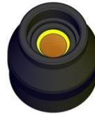
**Probenhaltering mit Prüfkörper aus Maskensand in die Prüfeinheit eingesetzter**
