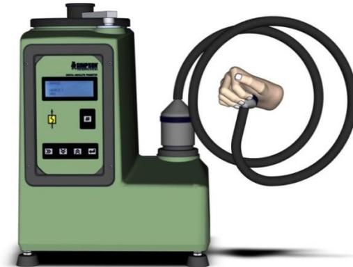
**Foto 5.5.1 - Abdichten mittels Hand des Zubehörs für Gasdurchlässigkeit an der Form**
