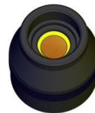
Anillo de retención del espécimen con la muestra con espaciador insertado
