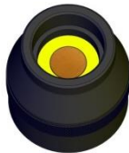
Anillo de retención del espécimen con la muestra insertada en el accesorio
