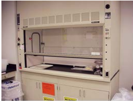
Figura 1: Campana de humos típica para laboratorio cerrado
