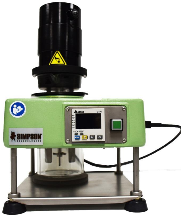
Figura 2: Ensamble del Agitador Rápido de Arena
