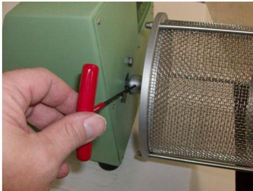
**Abbildung 3: Imbusschlüssel Schrauben Festziehen**
