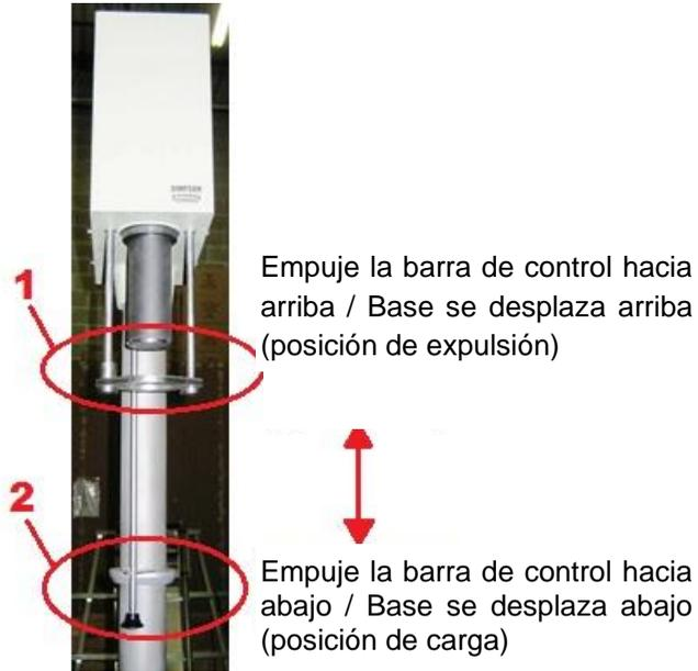
**Figura 8: Poste del Shatter Index Tester en la posición inferior cerrada**
