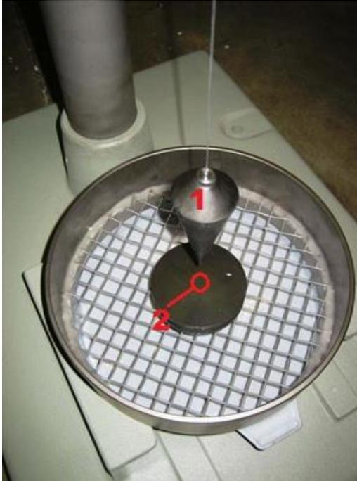
**Figura 5: Plomada (1) alinear en el centro del objetivo (2) para nivelar adecuadamente el Shatter Index Tester.**
