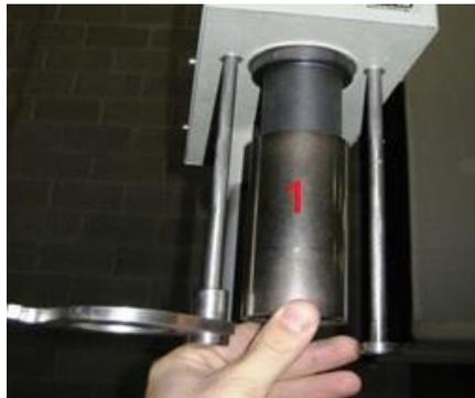
**Figura 10: 2 "x 2" (50 mm x 50 mm) tubo de muestra (1) situado en el poste del Shatter Index Tester**
