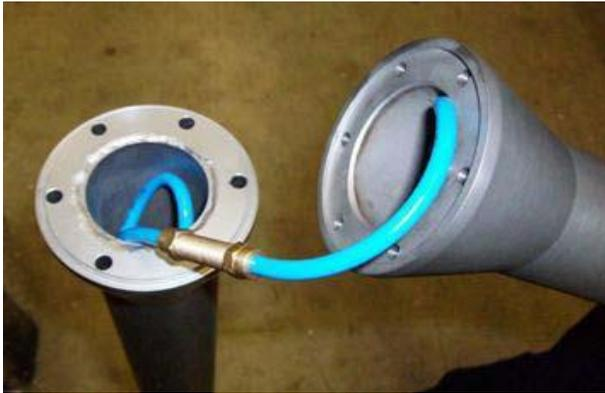
**Figura 1: Conexión de tubería neumática con acoplamiento neumática.**
