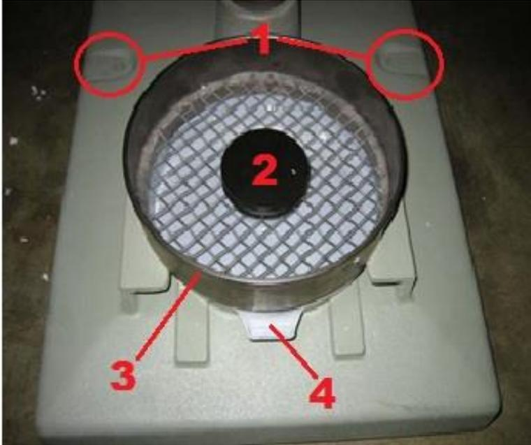
**Figure 3: Base del Shatter Index Tester con el tamíz de malla 1/2" (3), bandeja (4) y objetivo (2).**
