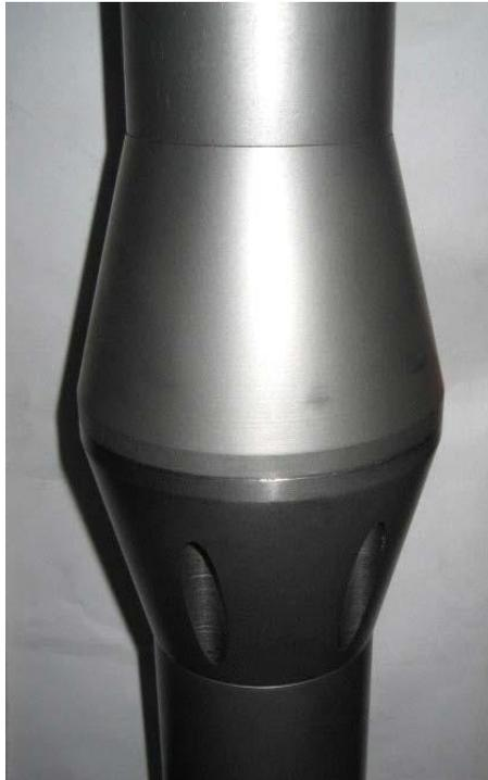
**Figura 2: Acoplamiento de las dos secciones del shatter index tester.**
